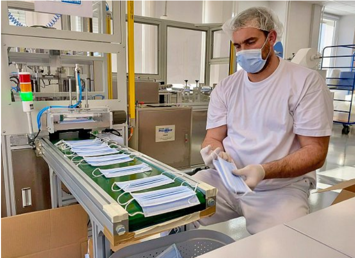
La machine toute neuve débite 95 masques à la minute à partir de bandes de polypropylène. DR
